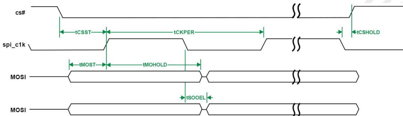
图 11: SPI 通信时序图如下
