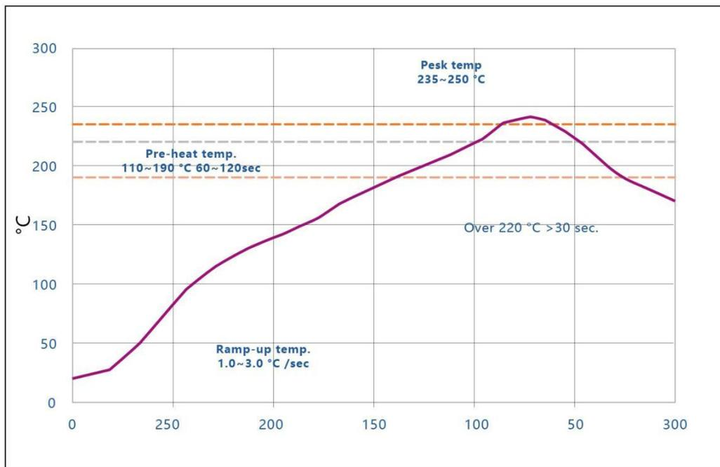
图 19: 推荐的回流焊温度曲线
