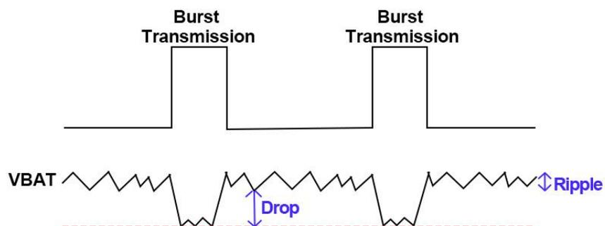
图 4: 突发传输电源要求
