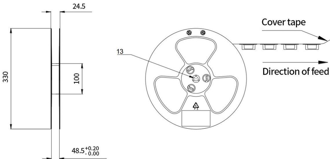
图 21: 卷盘尺寸 (单位: 毫米)
