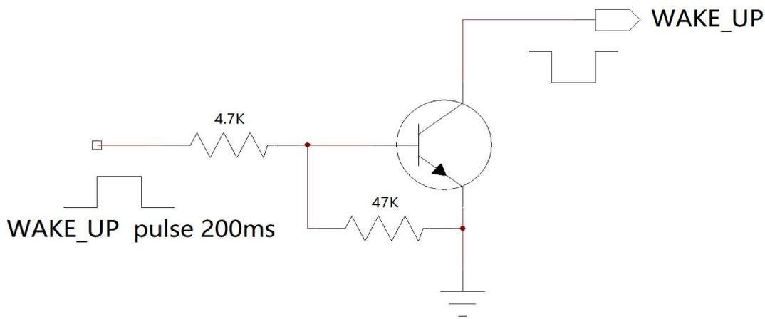
**图 8: 开集驱动唤醒参考电路**
