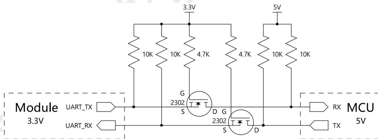
图 13: 串口电平转换参考电路
